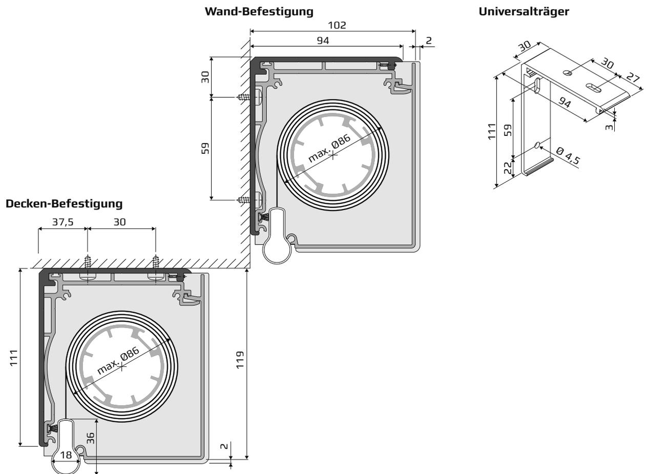
Typ 330 - Rollo Large mit eckigem Kassettenprofil und seitlicher Kettenbedienung
